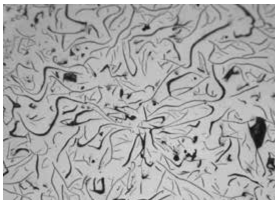
✓ چدن خاکستری با گرید (GGG25 (EN - GJI - 250) براساس استاندارد بین‌المللی DIN1691
